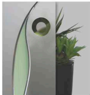
DEKORATIVNO VITRAJ STAKLO S FAZETOM I FOLIJOM - unutarnje staklo je satinato, na koje je nalijepljena fazeta - 4 boje na rubovima je folija - 5 boja i obostrano obrubljeno olovnom trakom.
