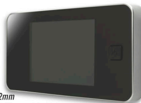
Vanjska dimenzija zurila Ø32mm ugradnja moguća u panele debljine od 38-110mm Dimenzija monitora 125x68mm - 3.2" kut gledanja 105°
